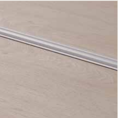
KOMBI-PROFIL, SILBER 1860 × 47 × 16 mm Dehnungsfugenprofil und Anpassungsprofil in einem. Geeignet für Höhenunterschiede von 0–12,3 mm. Höhe: 10 mm (nicht verlegt) Aluminium. PGPRSILV
